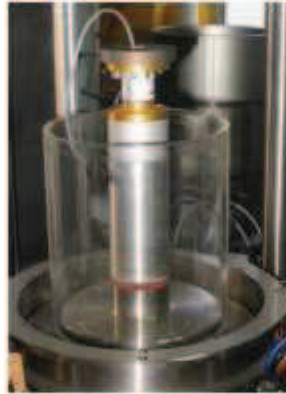
Figura A.1. L'apparecchiatura di taglio torsionale THOR.
